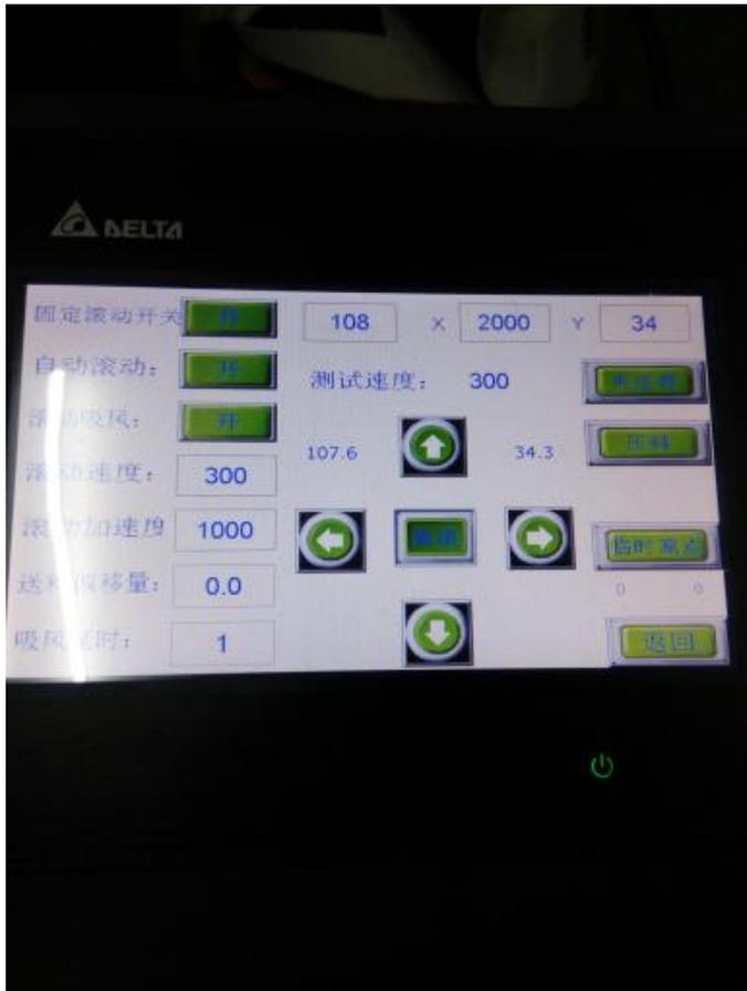
然后移动机器到第二个点，把第二个点的 X 坐标输入第二个框，如下图：
