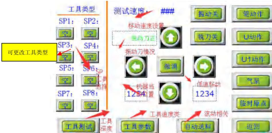
在工具类型下面 SP1-SP8，可以更改工具，工具类型分笔、U、U1，此处的工具号 SP1-SP6 与软件里代表颜色的 1、2、3、4、5、6，是一一对应的，比如 SP1:U, SP2: U1, SP3: 笔，软件设置颜色使用 1、2、3 即可。
