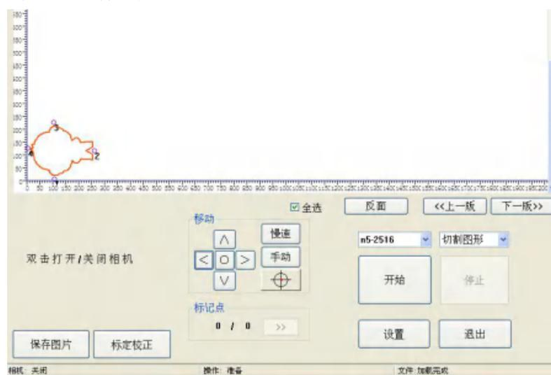
B. 鼠标双击点开摄像头，移动摄像头使第一个 mark 点出现在镜头内，点击“开始”自动读取 mark（标记）点，读取完成后会自动进行切割；
